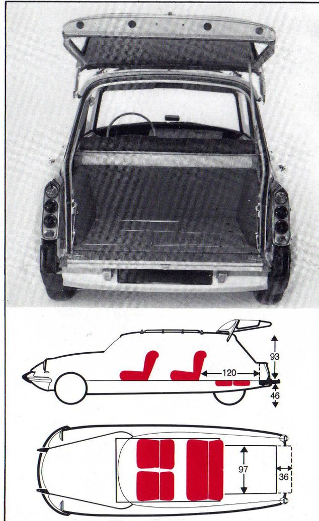
Aménagements intérieurs identiques à ceux de la berline ID "Confort". Sièges garnis de caoutchouc multicellulaire. Sièges avant réglables et inclinables, transformables en couchettes, accoudoir central escamotable à l'arrière.
