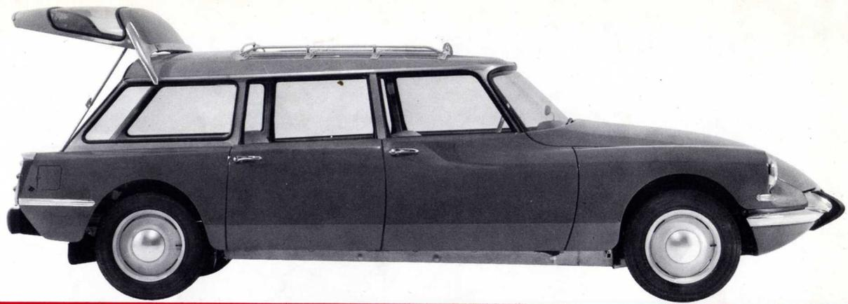
**L'arrière du break** (luxe ou confort) est fermé par une porte auvent qui s'ouvre vers le haut sur toute la largeur et un hayon qui s'ouvre vers le bas. La hauteur d'entrée est de 93 cm, l'une des plus grandes parmi les véhicules de ce type. Grâce à une charnière spéciale placée très en retrait par rapport à l'arrière de la voiture, l'auvent se relève très haut (il est maintenu ouvert par une béquille à deux positions) et l'accès à la surface de chargement est particulièrement commode.
