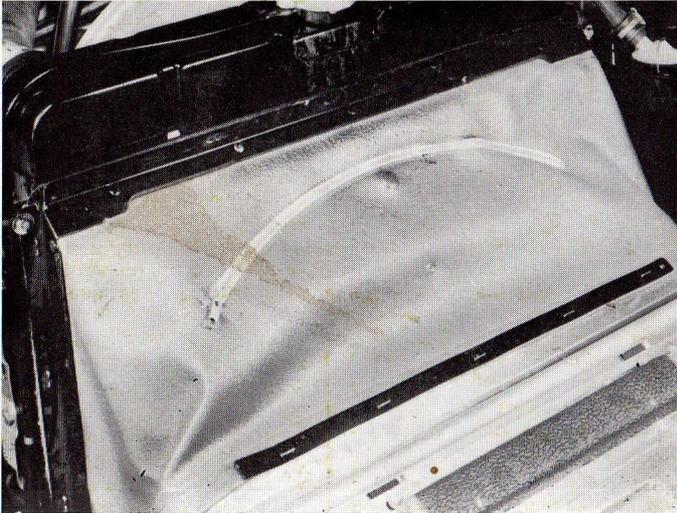
**Si votre voiture est équipée d'un des chauffages en option (— 5° ou — 15°) vous pouvez — par exception — maintenir l'échancrure ouverte à l'aide du bouton-pression lorsque la route est recouverte d'une couche de neige suffisamment épaisse pour provoquer l'obstruction de la grille protégeant l'entrée du conduit de ventilation.**
